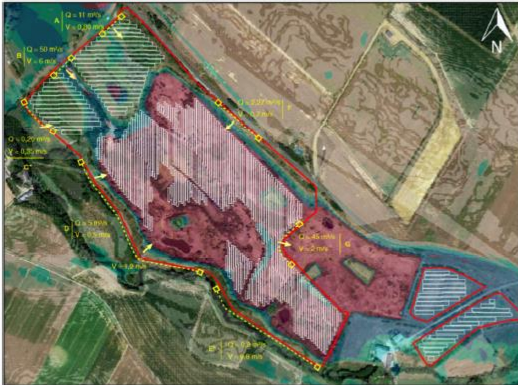
Cartographie des points d'embâcles identifiés par la modélisation hydraulique réalisée par GEOINTEC
