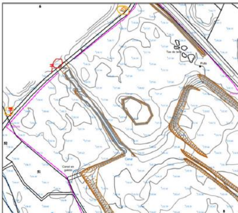
Extrait du plan topographique : côte du point d'entrée principal à l'Ouest du site identifiée par NEOEN, entourée en rouge (137.51 NGF) ; côte des deux autres points d'entrée identifiés pendant l'enquête, entourés en orange (138.43 NGF au Nord, 138.53 NGF au Sud)
